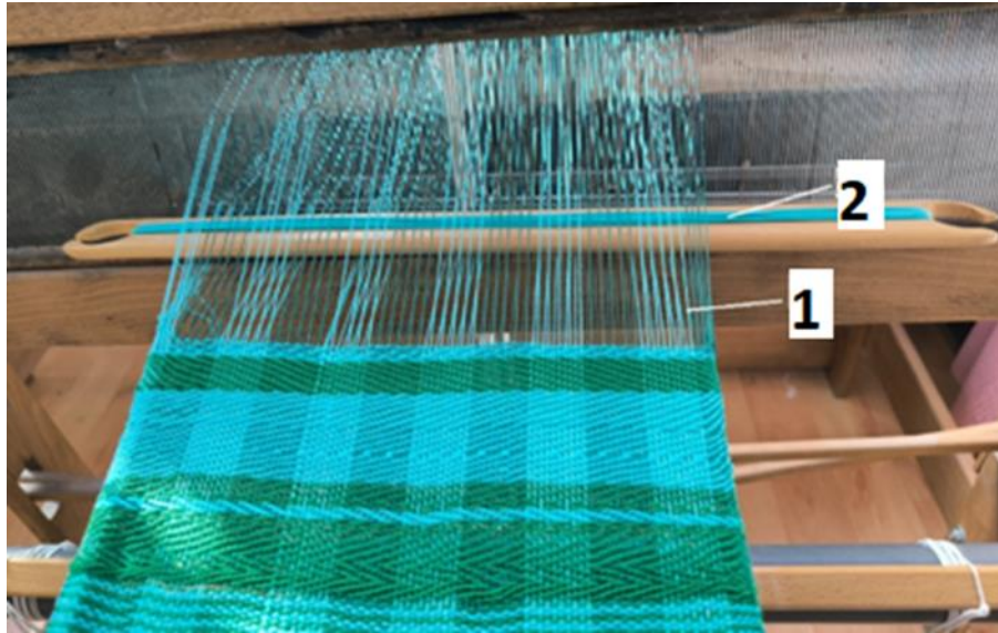
Slika 1.1. Formiranje tkanine na ručnom tkačkom razboju
