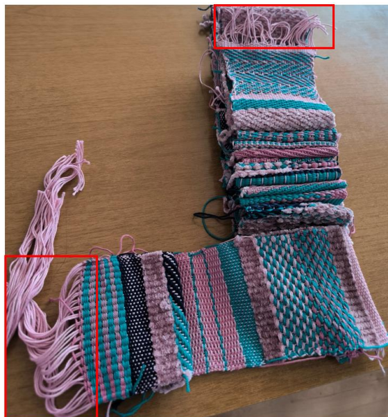
Slika 10.2. Dužina neutkanog dela pređe osnove pri početku i kraju tkanja – na početku i na kraju tkanine
