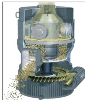
**Figure 9.** Press with flat die and rollers, ([www.akahl.de](http://www.akahl.de))
